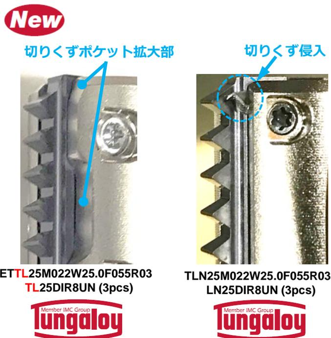
新製品は、工具先端と中央部の切りくずポケットを拡大したため、隙間への切りくず侵入を防止できた。
